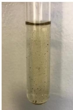
Pelas características da amostra, o material foi testado como filtro físico, pelo método de transmitância difusa recomendado para este tipo de filtro (VELASCO et al., 2011). Os dados da transmitância difusa foram obtidos e convertidos para valores de absorvância monocromática, em seguida calculado o FPS para a amostra E60, conforme resultado apresentado na TABELA 9 (DIFFEY; ROBSON, 1989; MCCORMICK; TSUZUKI, 2012).
