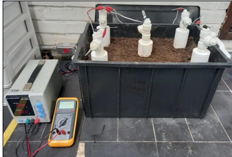
FIGURA 29 – FOTO DA ELETROREMEDIAÇÃO
