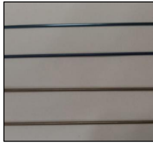
FIGURA 25 - COMPARATIVO DOS BASTÕES QUE SOFRERAM ANODIZAÇÃO COM OS QUE NÃO SOFRERAM
