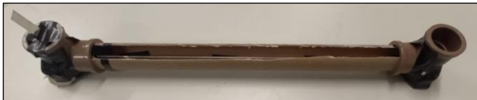
FIGURA 12 – CÉLULA ELETROQUÍMICA PARA A ANODIZAÇÃO
