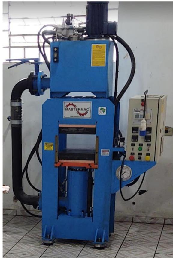
Figura 60 – Imagem da termoprensa utilizada na confecção de amostras
