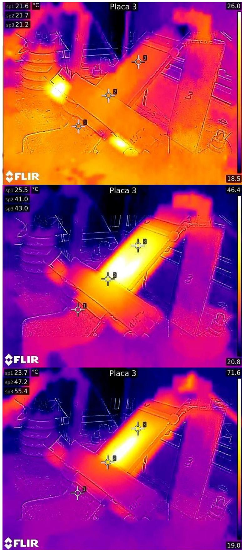
Figura 54 - Imagem térmica do processo de trilhamento elétrico
