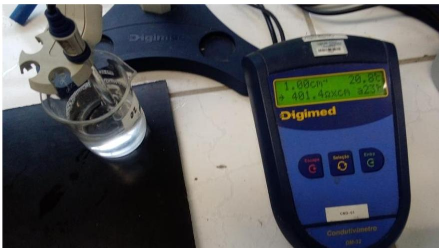
Figura 42 – Imagem do equipamento de medição da condutividade do líquido contaminante
