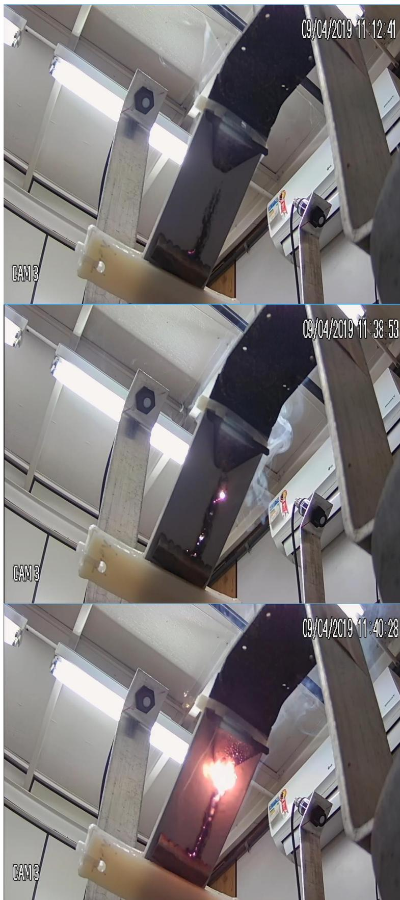
Figura 52 – Imagens da evolução do processo de trilhamento elétrico
