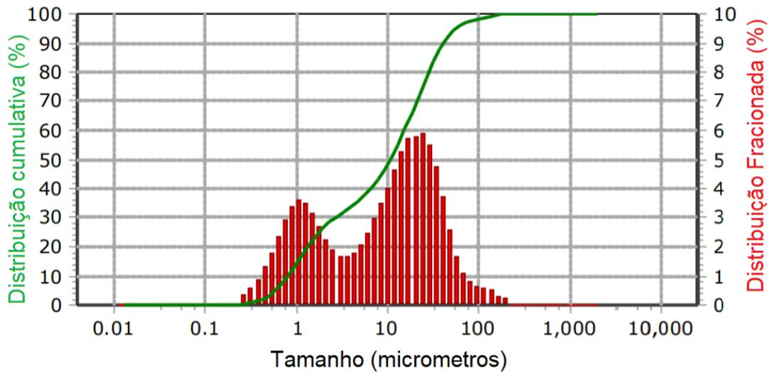
A distribuição do tamanho de partícula de PbO comercial genérico foi cedida pelo ISI-EQ, e mostra a distribuição cumulativa e fracionada gerada com auxílio do *software* do equipamento Bluewave Microtrac.
