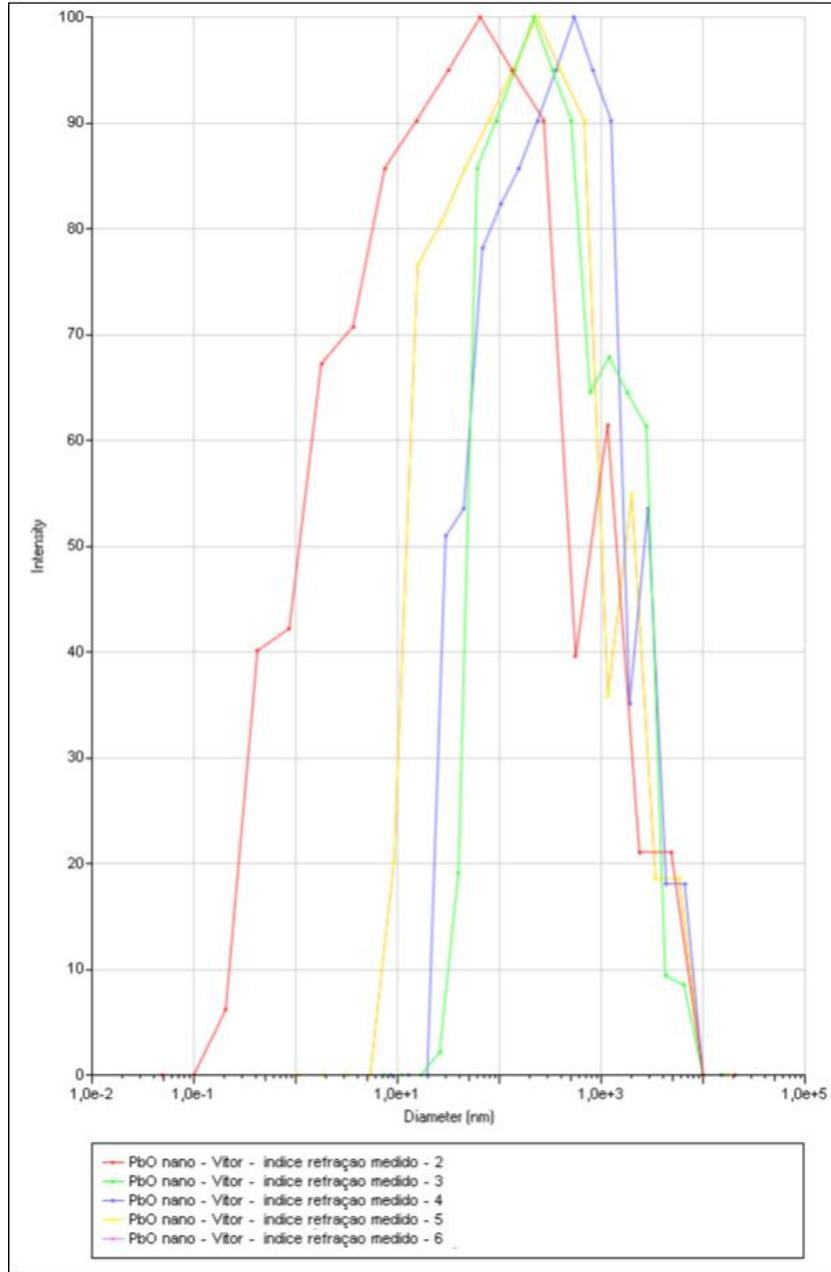
A distribuição do tamanho de partícula de  $\alpha$ -PbO mostra a intensidade em função do tamanho da partícula após 5 determinações e foi gerada no *software* do equipamento *Zetapals*.
