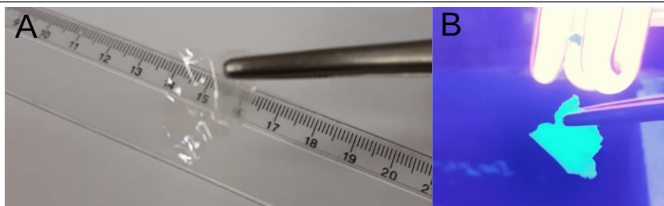
Figura 30. (A) Fotografia do filme autossustentável do polímero LaPPS75 e (B) fluorescência do filme sob luz UV ( \lambda_{\text{exc}} : 360 nm).
