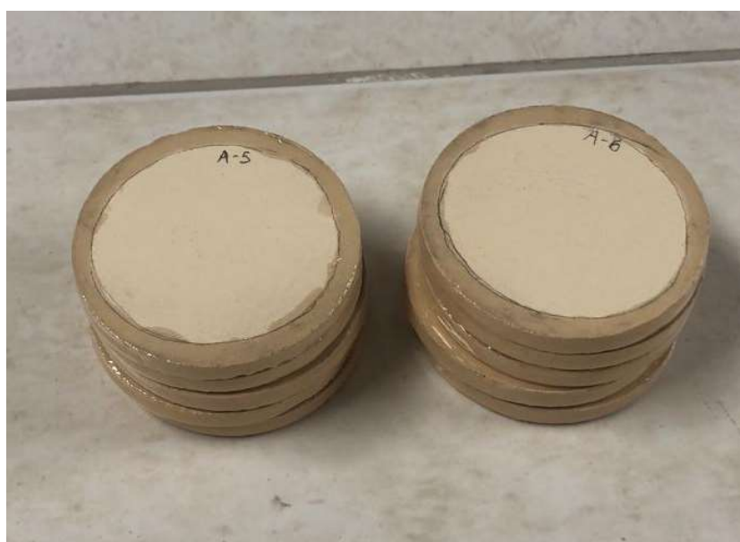
Figura 17 - Membranas de cerâmica de argila tratada com aditivo de óxido de titânio.
