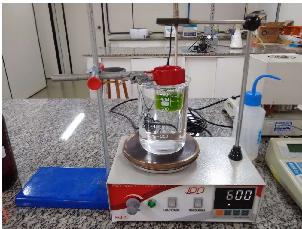
Figura 25 - Sistema montado para os ensaios de floculação.
