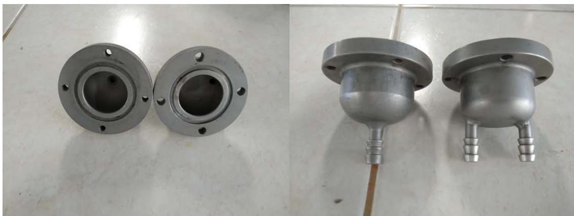
Figura 14 - Módulo de filtração.
