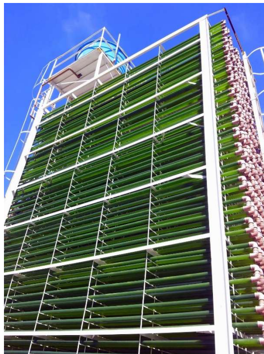
Figura 5 - Fotobiorreatores tubulares compactos do NPDEAS.
