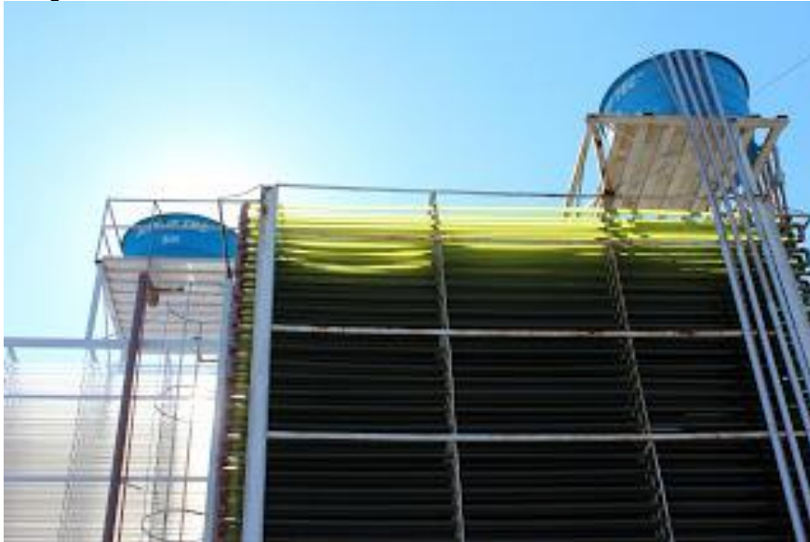
Figura 8 - Fotobiorreatores de tubos horizontais utilizados no NPDEAS.
