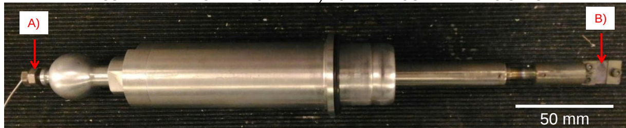
FIGURA 16 – BRAÇO COM O PORTA-AMOSTRA PARA MEDIDAS DE GISAXS IN SITU : A) PASSANTÉ PARA O TERMOPAR E B) PORTA-AMOSTRA PARA GISAXS.
