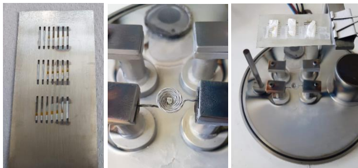
FIGURA 20 - MÁSCARA PARA DEPOSIÇÃO DE AL, CADINHO DE TUNGSTÊNIO E MONTAGEM DAS LÂMINAS PARA EVAPORAÇÃO DO AL RESPECTIVAMENTE (DO AUTOR).
