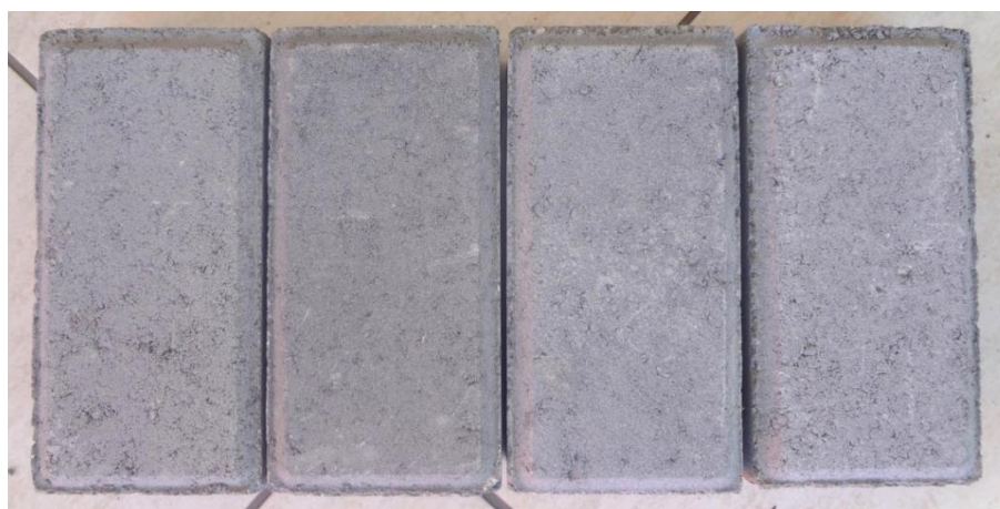
FIGURA 4.18 - CORPOS DE PROVA NA INSPEÇÃO VISUAL: ADF SILICATO, ADF FENÓLICA, ADF VERDE E AF
