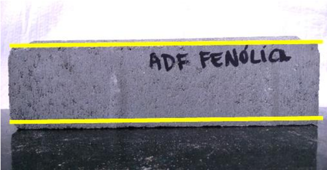
FIGURA 4.16 - RUGOSIDADES NAS AMOSTRAS DE PAVER ADF FENÓLICA
