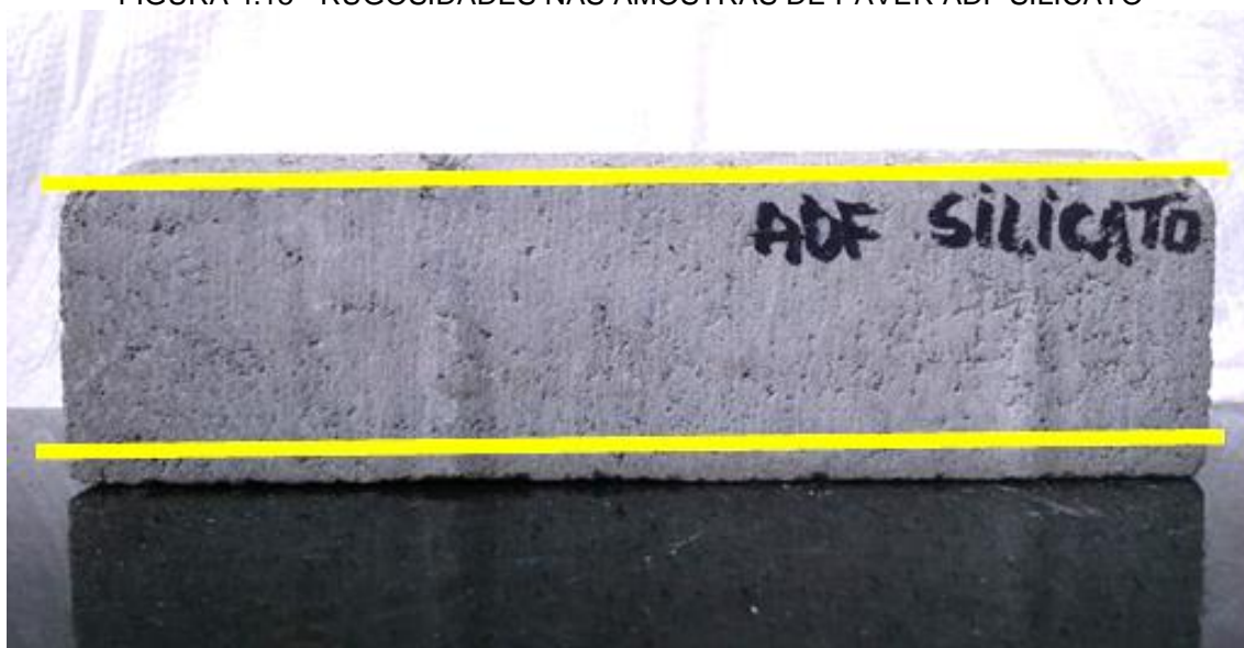
FIGURA 4.15 - RUGOSIDADES NAS AMOSTRAS DE PAVER ADF SILICATO
