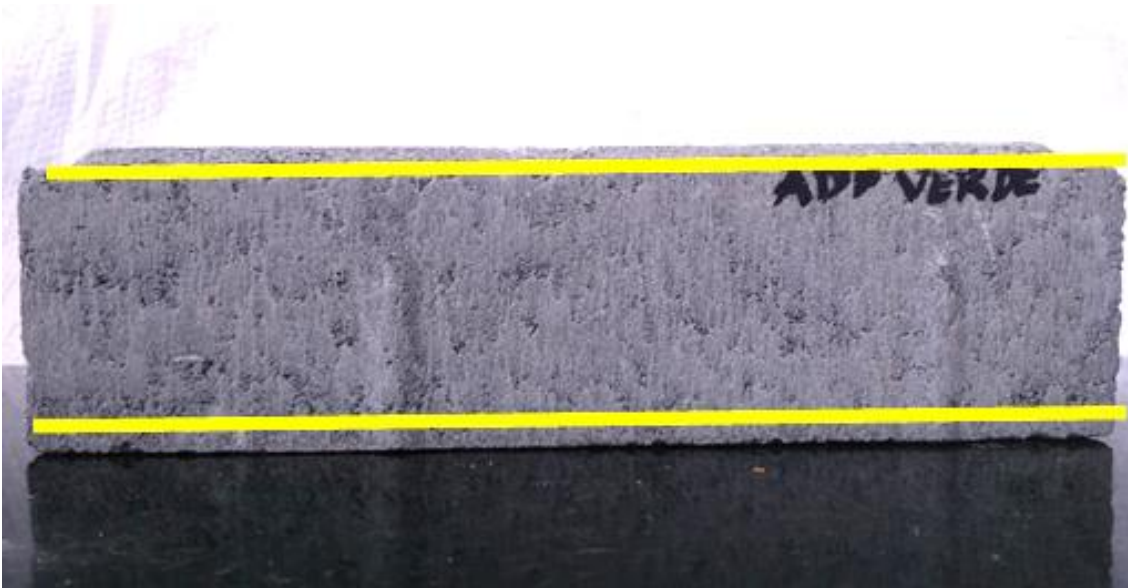
FIGURA 4.17 - RUGOSIDADES NAS AMOSTRAS DE PAVER ADF VERDE
