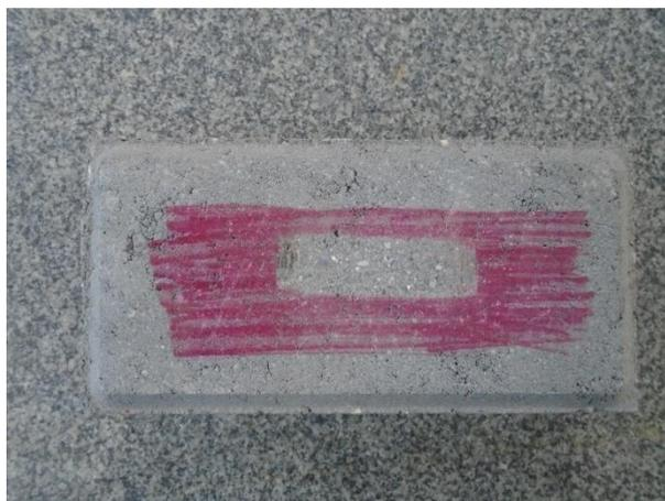
(b) Paver após o ensaio de abrasão
