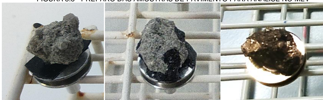
FIGURA 3.5 - PREPARO DAS AMOSTRAS DE PAVIMENTO PARA ANÁLISE NO MEV
