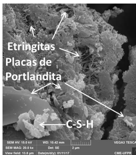
(b) ADF Fenólica Região destacada (a) em 20.000x
