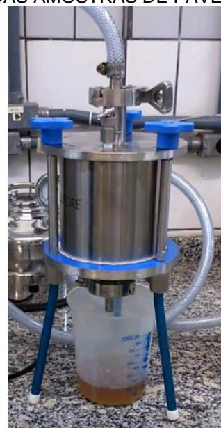
(b) Filtração pressurizada para obtenção de extrato solubilizado.
