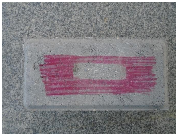
(b) Paver após o ensaio de abrasão
