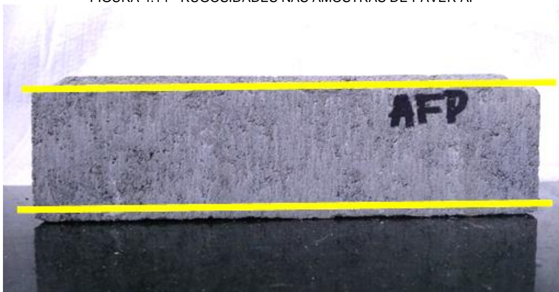
FIGURA 4.14 - RUGOSIDADES NAS AMOSTRAS DE PAVER AF
