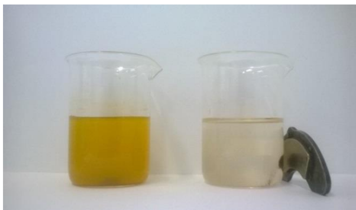
FIGURA 49 - IMAGEM ILUSTRATIVA DA PRINCIPAL VANTAGEM EM SE UTILIZAR MATERIAL LAMELAR COM SUPORTE MAGNÉTICO: SEPARAÇÃO SÓLIDO-LÍQUIDO.
