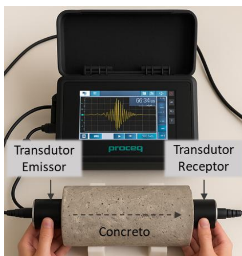
Figura 1: Configuração dos transdutores no ensaio de pulso ultrassônico
