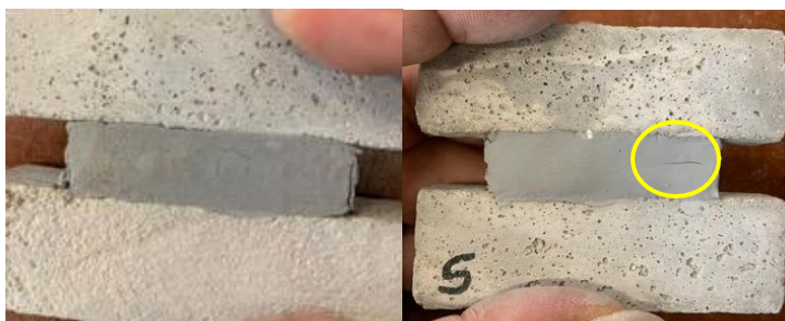
Figura 8: Falhas coesivas e adesiva nas amostras com selante MS após o condicionamento EC, antes da sua submissão ao ensaio de tração
