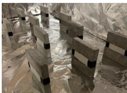
Figura 6: Amostras de argamassa com selantes dentro da estufa de calor, gerado por incidência de lâmpadas halógenas, durante o ensaio de envelhecimento no condicionamento EC
