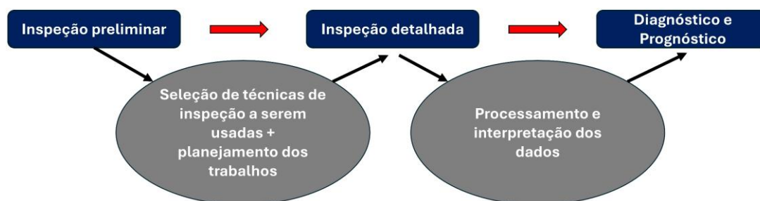
Figura 1: Fluxograma de etapas do processo de inspeção
