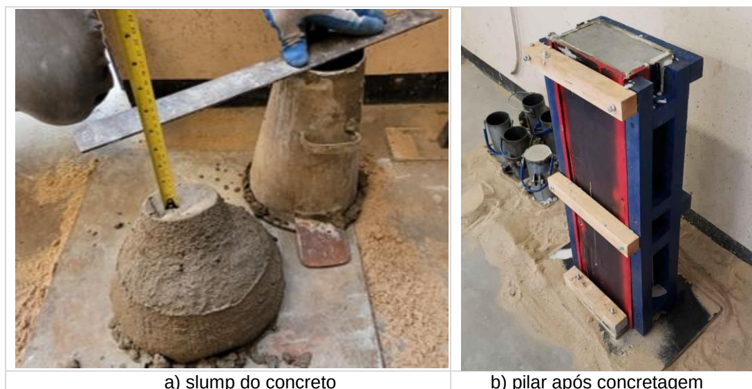
Figura 1: Moldagem do pilar
