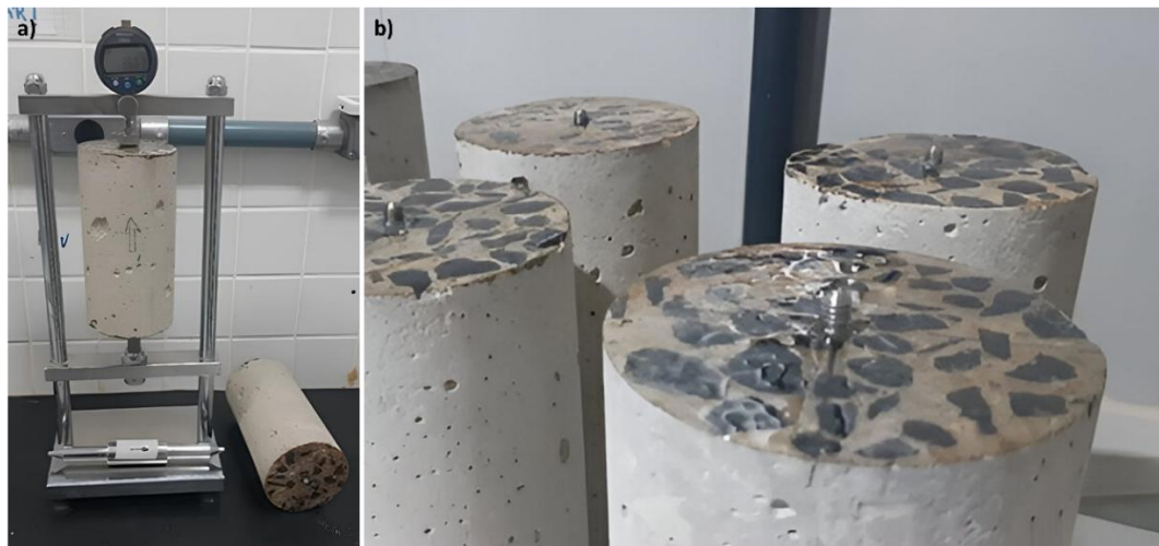
Figura 3: (a) Medição dos corpos de prova cilíndricos no relógio comparador e (b) representação após colagem dos pinos com cola epóxi
