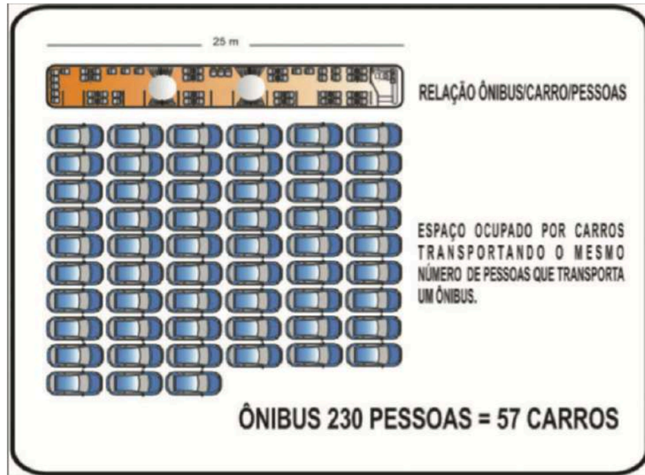
FIGURA 8 – SIMULAÇÃO DO NÚMERO DE PASSAGEIROS POR MODAL DE TRANSPORTE (ÔNIBUS BIARTICULADO E VEÍCULOS PARTICULARES).
