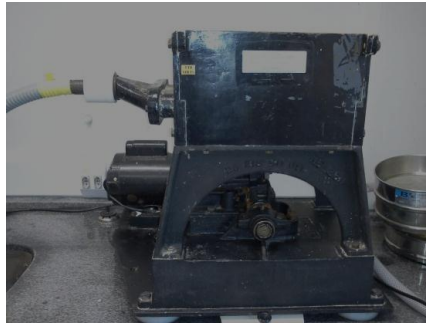
Figura 3 – Depurador TMI modelo Valley Flat Screen . Fonte: Os AUTORES.
