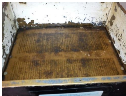
Figura 6 – Polpa rejeitada pela peneira de rasgos. Fonte: Os AUTORES.
