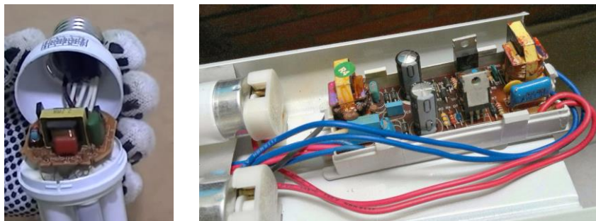
Figura 1 – Porção eletrônica de acionamento das LF compactas e do reator das LF tubulares Fontes: CORREIA (2016) e PORTAL ELETRECISTA (2018), respectivamente.
