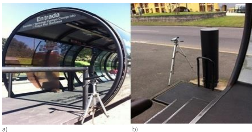
Figura 5 – Métodos de instalação para avaliações acústicas para todos os pontos de medição. a) Vista da parte externa a Estação-Tubo, próximo a via de tráfego. b) Vista da parte interna a Estação-Tubo, próximo a superfície cilíndrica da Estação-Tubo.
