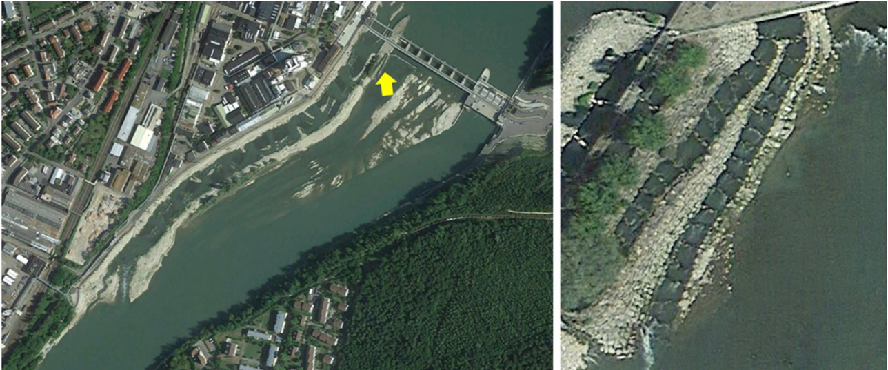
Figura 7.9 – Escada para peixes junto ao canal de fluxo mais forte (a), assinalado com seta e ampliada em (b)
