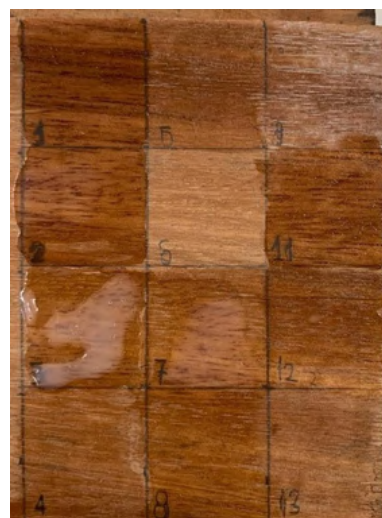
Figura 2 - Aplicação em madeira dos ensaios realizados na metodologia “Quantidade ideal de solvente para a degradação do isopor e desempenho como verniz”.
